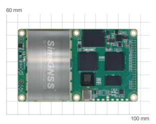
Size(L  $\times$  W  $\times$  H): 100 mm  $\times$  60 mm  $\times$  9 mm
